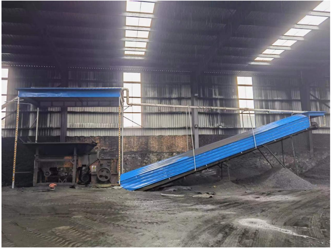
图 3-2 集气罩+密闭传送带
